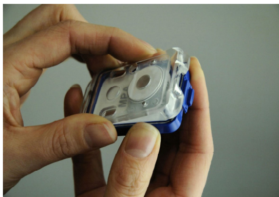
Bild 6: Einhängen des Deckels an der Rückschale
