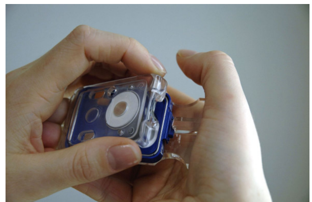
Bild 4: Öffnen der Kassette durch Abnehmen des Deckels
