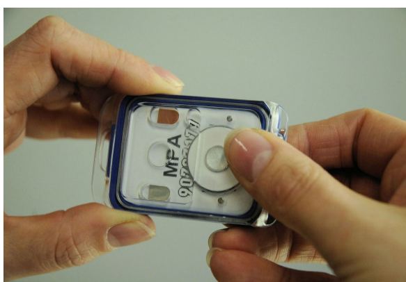
Bild 7: Drücken des Deckels auf die Rückschale
