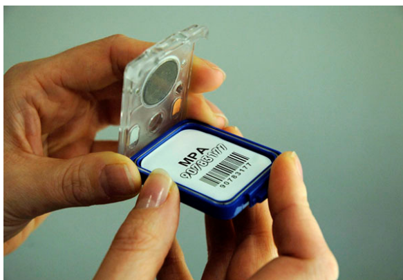
Bild 5: Einhängen des Deckels an der Rückschale
